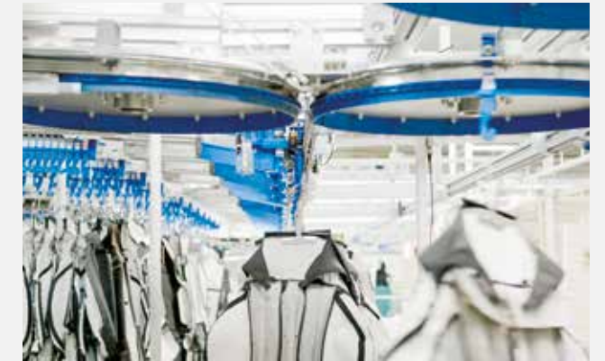
Dynamisches Lager: Filtern und Transport der benötigten Bezüge zum Sorter
